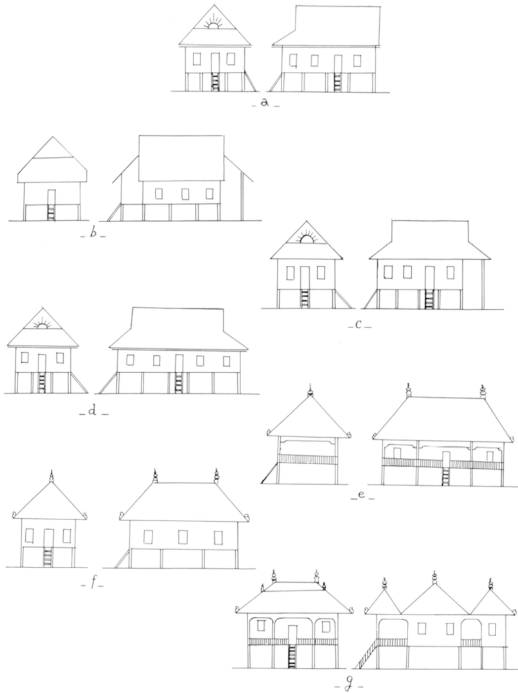
Pl. III. -- Fig. a : Maison roñ ʔol du troisième type ; fig. b : Maison roñ dioèñ du premier type ; fig. c : Maison roñ dioèñ du second type ; fig. d : Maison roñ dioèñ du troisième type ; fig. e : Maison pit du premier type ; fig. f : Maison pit du second type ; fig. g : Maison pit du troisième type.
