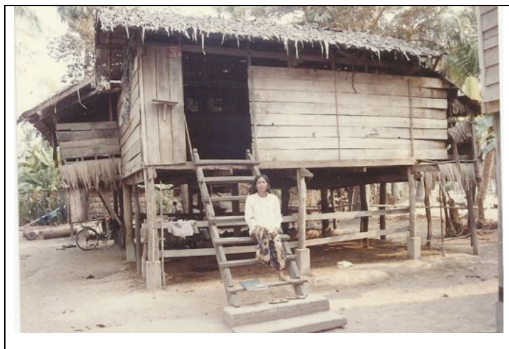
Fig. 11 : Façade Nord - maison provisoire à un toit en paillotte. Le bois acheté petit à petit est rangé sous la maison (dans le sens de la panne faitière) en prévision de la construction d'une maison plus durable. Au premier plan, la cuisine extérieure. (Photo F. Luco 1995)
